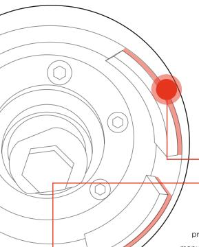
Les volants moteurs d'origine des VTT Suzuki Eiger 400 2002-2007 et Arctic Cat 400 2003-2008 ont des problèmes récurrents. Les additifs dans l'huile du moteur dissolvent l'époxy servant à maintenir les aimants en place, causant ainsi leur détachement et leur dispersion dans le moteur.
